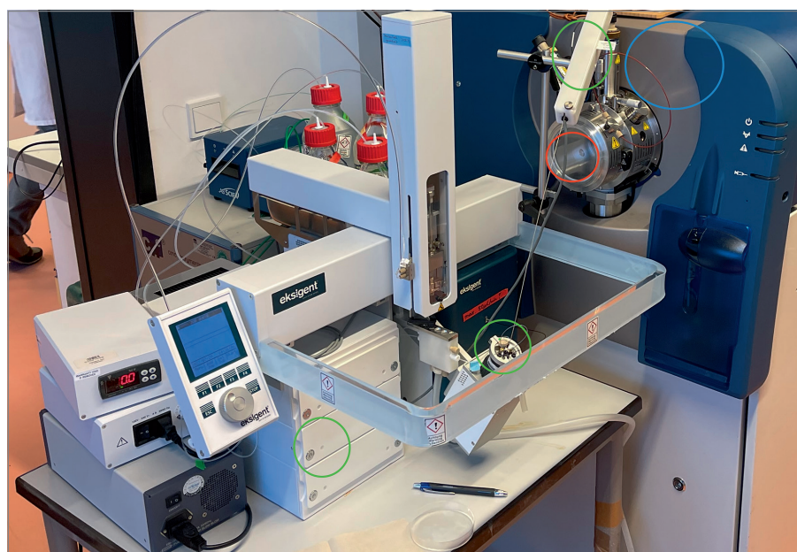
Abb. 1: Verwendetes LC-MS/MS-System bestehend aus (von links nach rechts) Probentray (gekühlt), Injektor, Säule mit Säulenofen (jeweils markiert mit grünem Kreis), Elektrospray-Interface (rot) und Massenspektrometer (blau). Das verwendete Massenspektrometer ist ein triple-ToF 4600 (ABSciex, Darmstadt, Deutschland) mit CID-Technologie als Fragmentierungstechnologie und einem Flugzeitmassenspektrometer (time of flight, ToF) zur Bestimmung der Molekülmassen © S. Wittke
